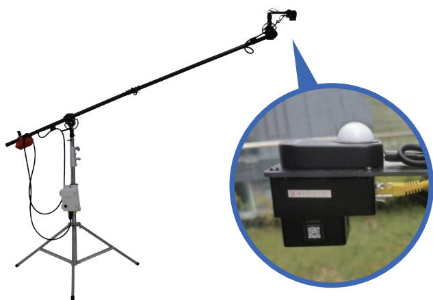
移动便携式多光谱测量仪MS400G1
