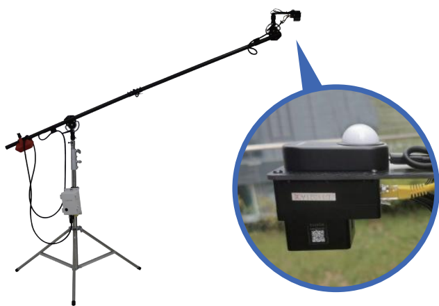
移动便携式多光谱测量仪MS400G1
